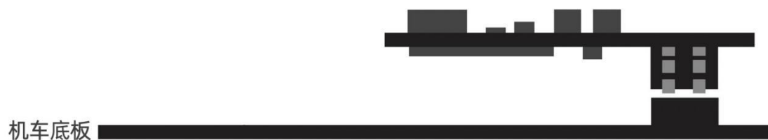
图 4-1:PluX22 解码模块安装示意图
